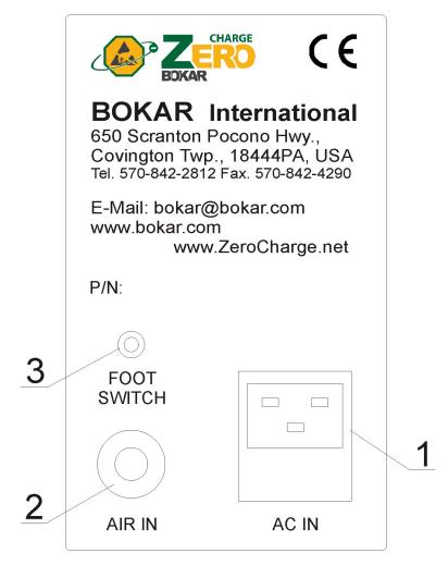
FIG. 3 VIEW OF THE BACK PANEL
